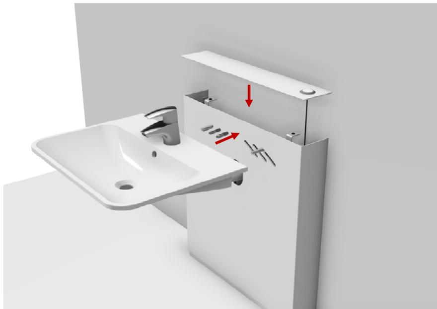
Das Waschbecken mit den beigefügten Montageteilen festbolzen, und danach die obere Platte in Position schieben.
