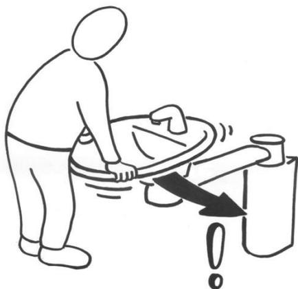
Das Ropox Schwenkbare Waschbecken hat eine Drehfunktion und darf deshalb **NICHT** als Stützengriff oder Stehstütze benutzt werden
