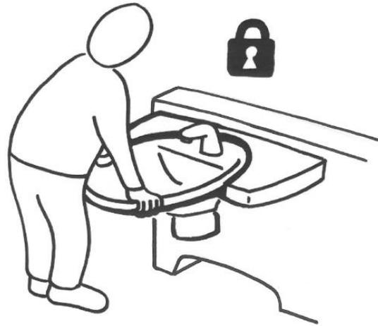
Das Ropox Schwenkbares Waschbecken hat eine Drehfunktion und darf deshalb **NICHT** als Stützengriff oder Stehstütze benutzt werden.
