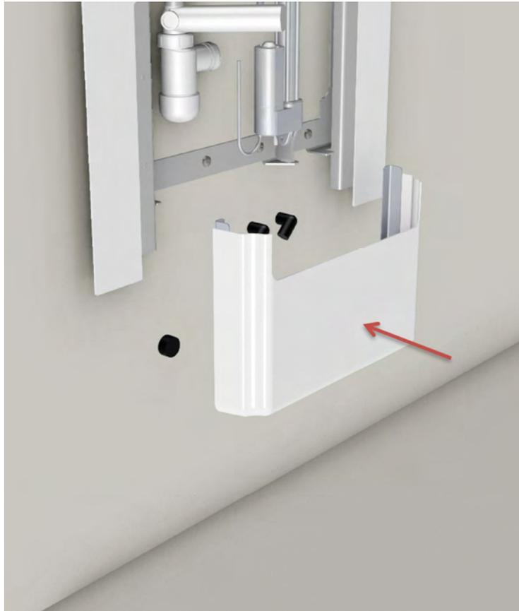
Die Schutzfolie vom doppelklebenden Klebstreifen auf der Rückseite der Beschläge für die Installationsabdeckung entfernen.
