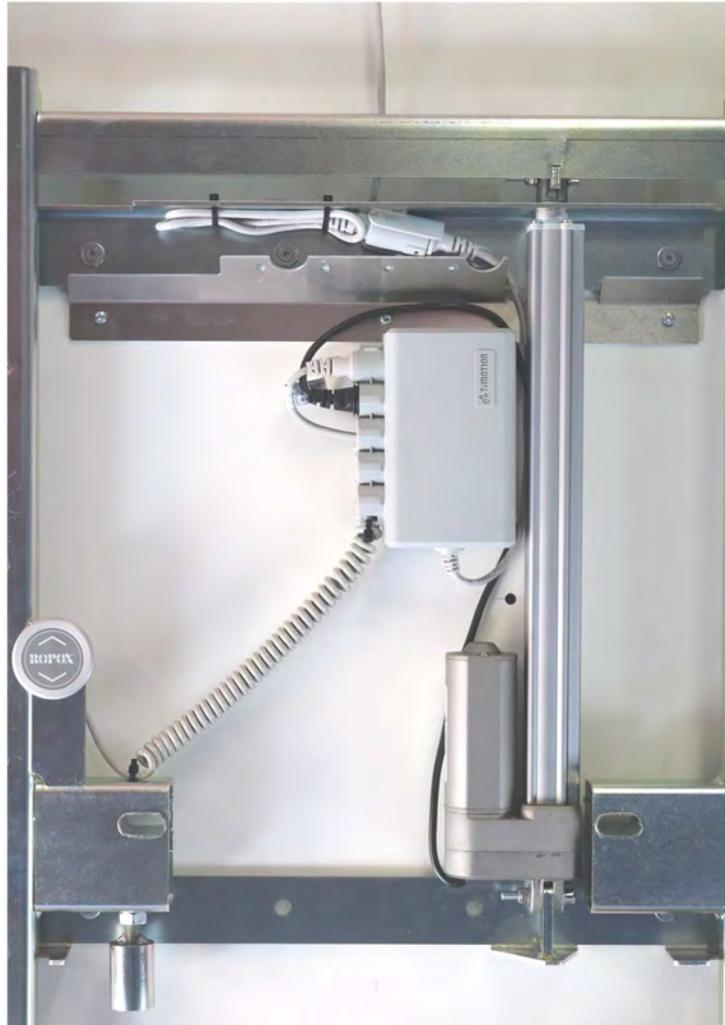
Das elektrische System wie abgebildet anschließen. Das überschüssige Kabel der Stromversorgung auf dem Montagebeschlag mit Strips befestigen.
