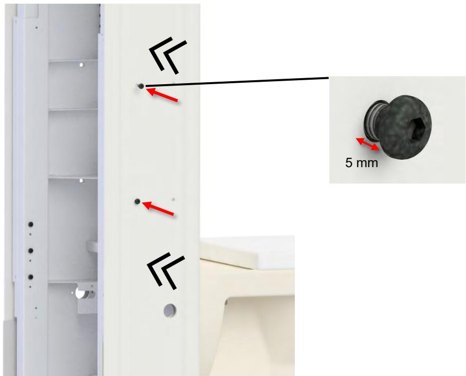
**C.** Die Montage nach oben schieben, so dass die Schraubenköpfe die Spur im Profil erfassen. Die Montage mit 2x M6x30 einschl. Spanscheiben befestigen.
