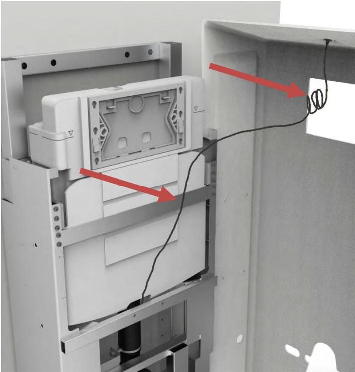
**d.** Wie angewiesen, das Bedienkabel zum Band vor dem Spülkasten mit Streifen befestigen. Die überflüssige Kabelmenge aufrollen und sie zu einer Schleife so nah wie möglich zum oberen Teil der Abdeckkappe mit Streifen befestigen.
