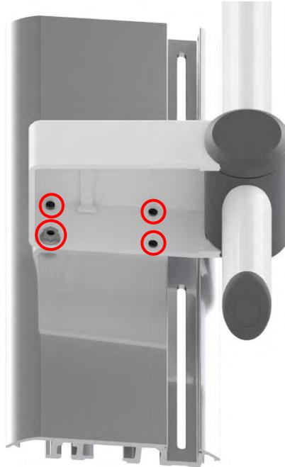
**b.** Sicherstellen, dass die Kunststoffkappe so weit wie möglich gegen den Metallrahmen verschoben ist. 2x M6-Knopfschrauben in den hinteren Löchern auf jeder Seite des Toilettenhebers montieren. Einen Abstand von 5mm zwischen dem Schraubenkopf und der Kunststoffkappe einhalten.
