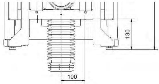
**b.** Bevor der Rahmen an der Wand befestigt wird, sind Wasser und Strom anzuschließen.
