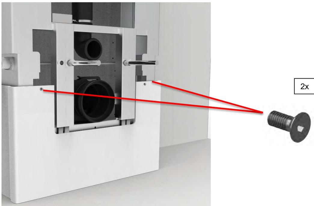
**g.** Die Außenkappe montieren (wird die Außenkappe mit der Bedienung oben montiert, siehe 4.4.3 – Montage der Bedienung oben an der Abdeckkappe).
