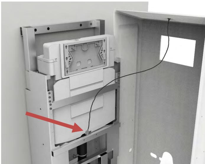
**b.** Führen Sie das Kabel der Vorderseite des Toilettenhebers entlang und hinter der Abstützung am Boden des Spülkastens.
