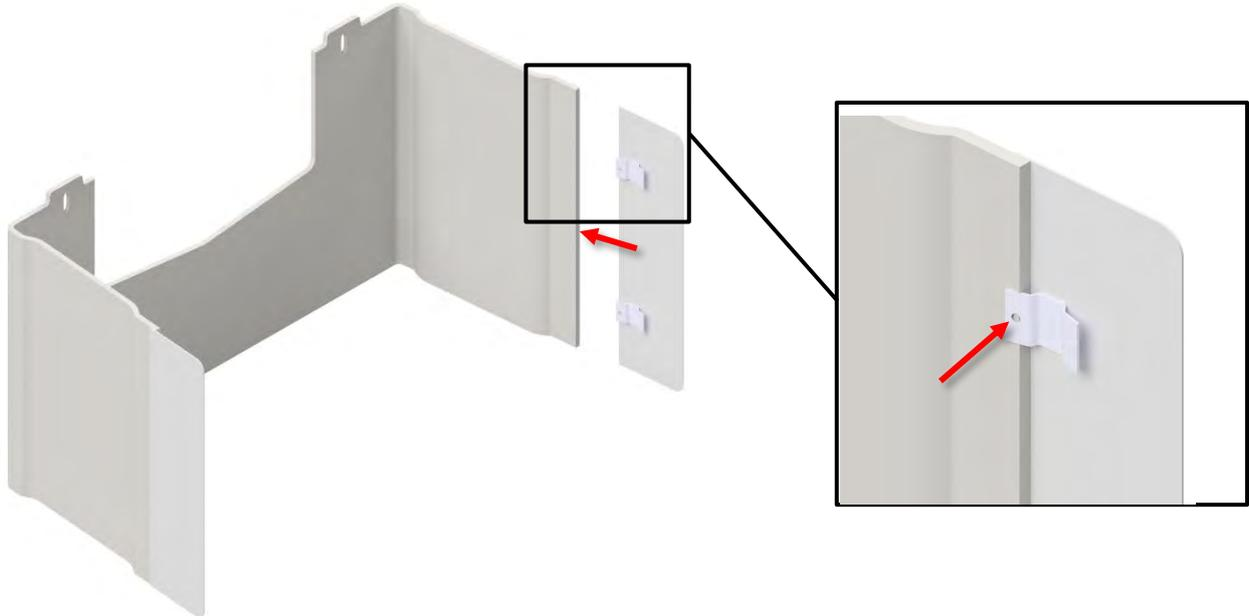
**b.** Die äußere Kappe niederdrücken und danach den Oberteil montieren.
