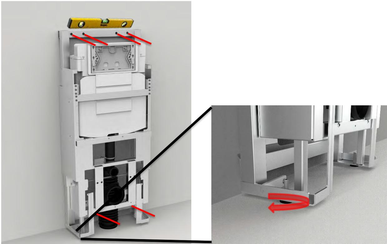
**a.** Den Rahmen mit Gewindefüßen und Wasserwaage einstellen. 6 Löcher markieren und eine entsprechende Bohrgröße für die Dübel verwenden. Sicherstellen, dass vom Boden zur Mitte der beiden unteren Löcher ein Abstand von mindestens 130mm eingehalten wird.
